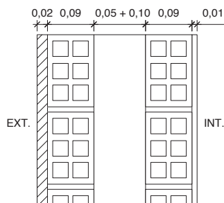
C011 Doble fabrica de maó foradat 9 (totxana) + cambra 10
